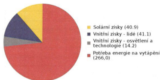
Bilance potřeby energie na vytápění (MWh/rok)
